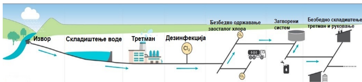
Слика 3-1 Пример приступа са вишеструким баријерама за обезбеђивање безбедног снабдевања питком водом (аутор, засновано према: WHO, 2023a)
