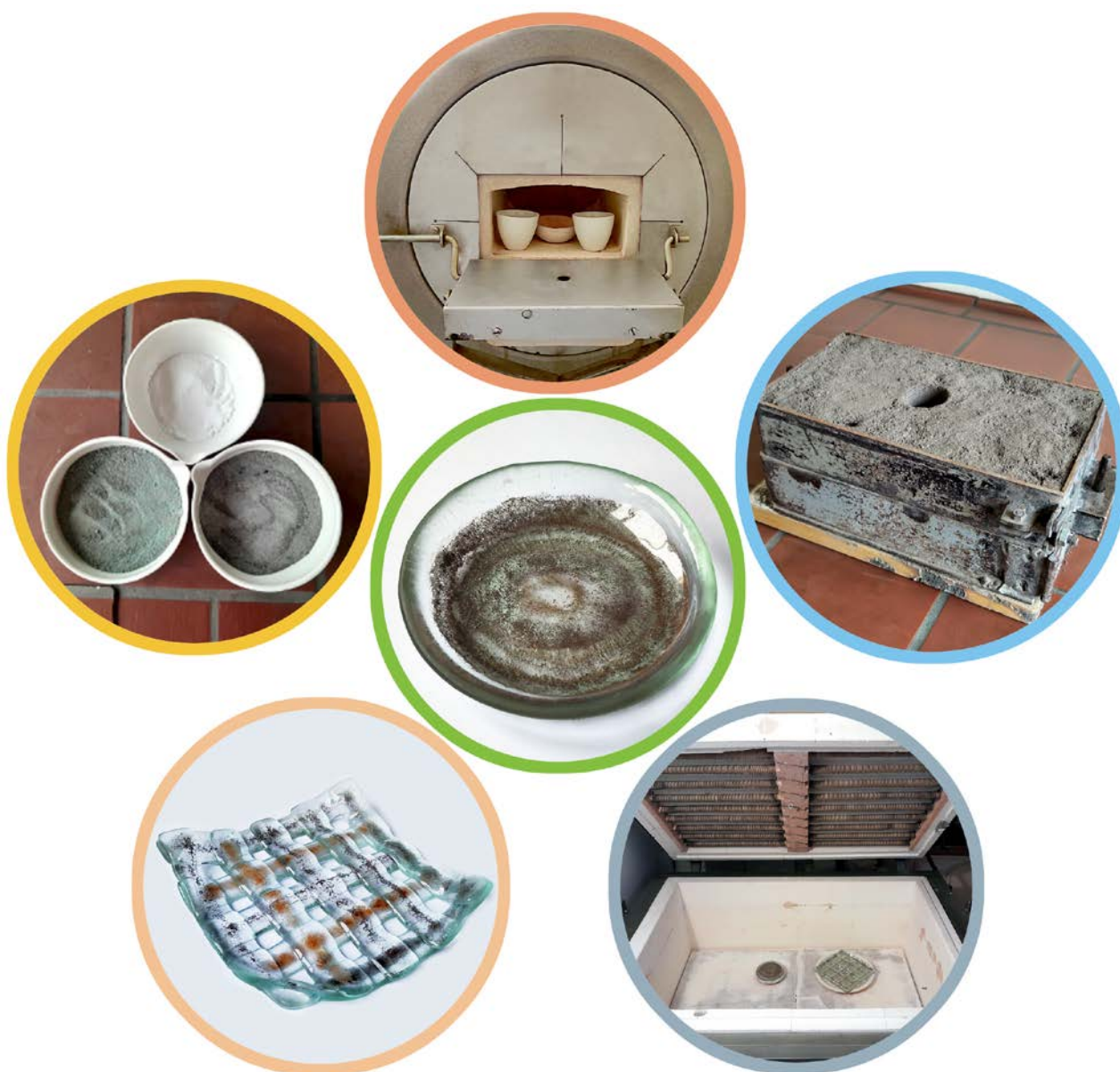
Слика 3.7 Добијање еко-синтерованог и индустријског производа
