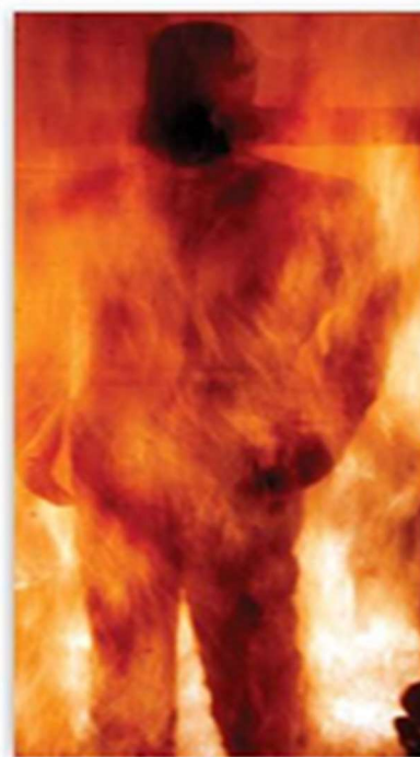
Слика 3.7. Пожарна лутка
